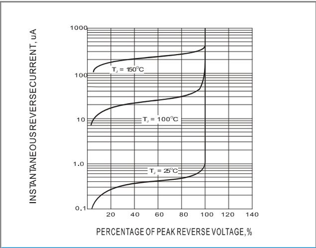
**Fig.5-TYPICAL REVERSE CHARACTERISTIC**
